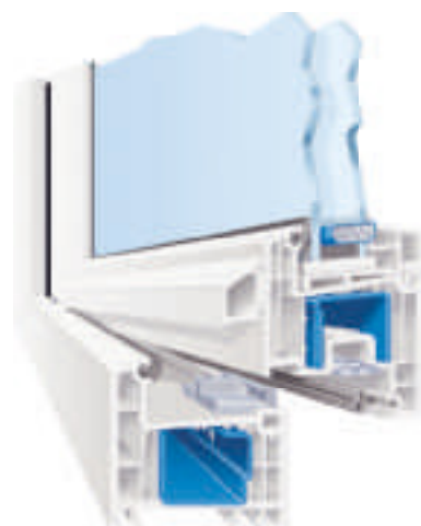
Systemschnitt Castello flächenversetzt
