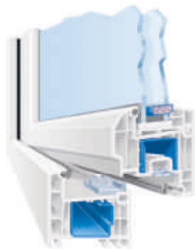
Systemschnitt Castello halbflächenversetzt
